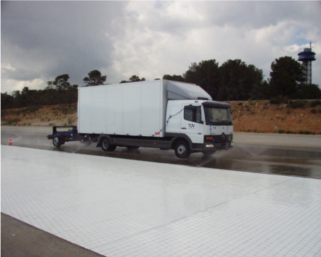
Abbildung 3: Nassbremsung mit Versuchsanhänger, Reifengröße 215/75 R17,5
