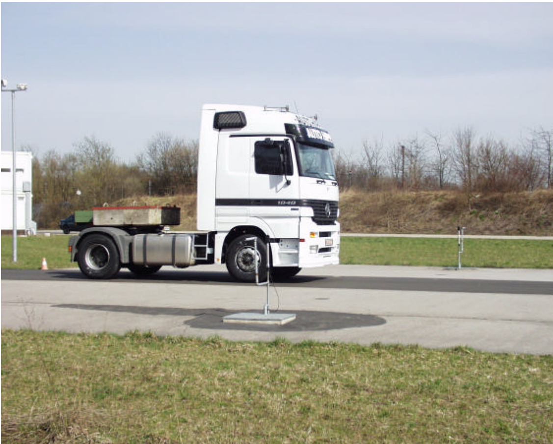
Abbildung 2: Geräuschmessung MB Actros, Reifengröße 315/80 R22,5
